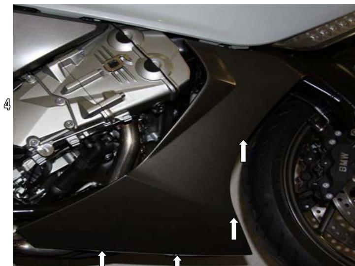
5. Entfernen Sie die Seitenverkleidungshalterung. (Abb. 5)
