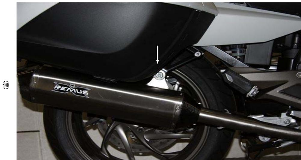
6. Positionieren Sie die REMUS Komplettanlage und ziehen Sie alle Schrauben fest.
