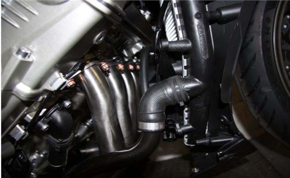
2. Stecken Sie die 3-1 Zusammenführung links und rechts auf den Krümmer und fixieren Sie diese mit den mitgelieferten Federn. Schrauben Sie die Lamdasonde wieder ein. (Abb. 8)
