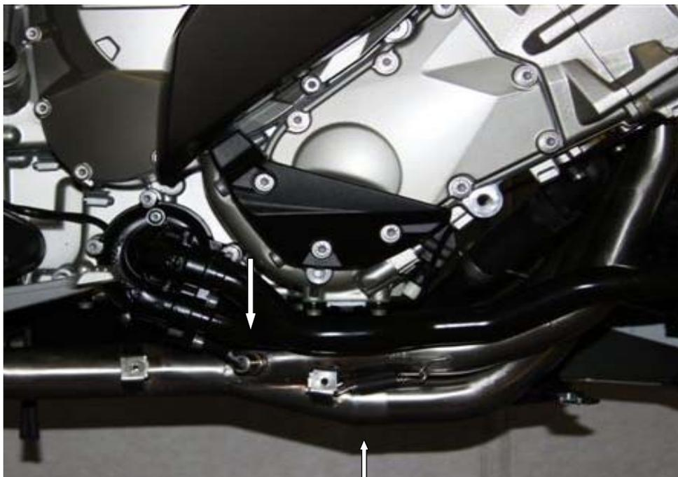
3. Verbinden Sie den REMUS Schalldämpfer mit dem REMUS Verbindungsrohr
