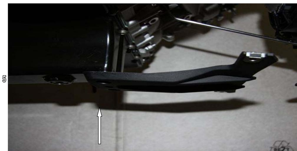
6. Lösen Sie die sechs Flansche der Krümmerrohre und nehmen Sie den originalen Krümmer ab. (Abb.6)
