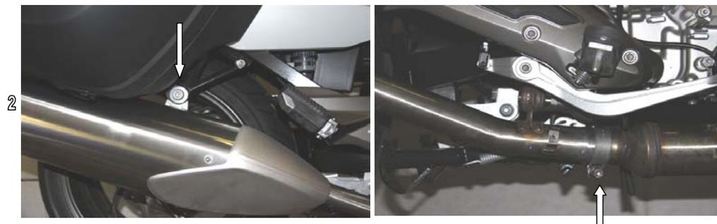
3. Schrauben Sie die Lamdasonde aus dem linken und rechten Krümmer. (Abb.3)
